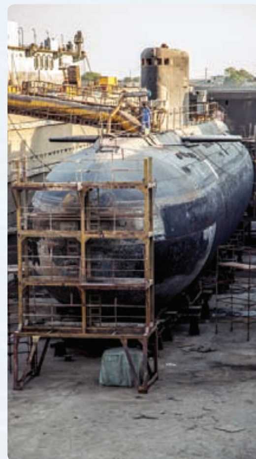
زیر دریایی کلاس سنگین یونس در حال تعمیرات در حوضچه خشک
