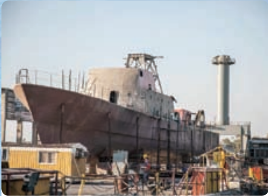
ناوچه موشک انداز کلاس سینا در حال ساخت در کارخانجات نیروی دریایی
