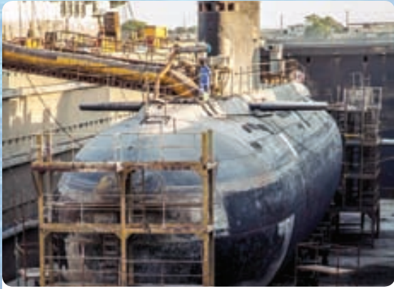
زیر دریایی کلاس سنگین یونس در حال تعمیرات در حوضچه خشک کارخانجات
