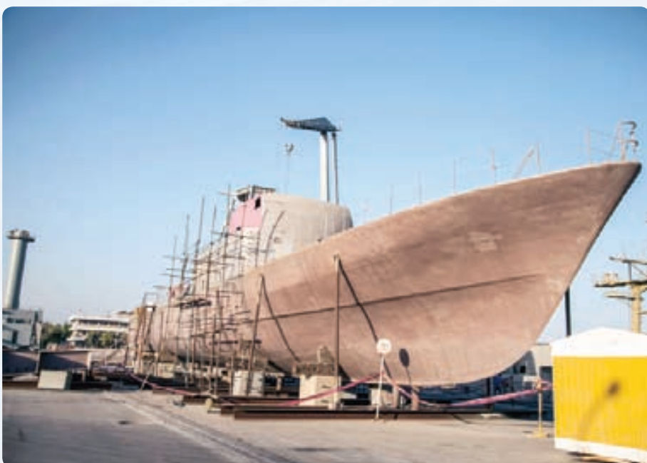
ناوچه موشک انداز کلاس سینا در حال ساخت در کارخانجات نیروی دریایی
