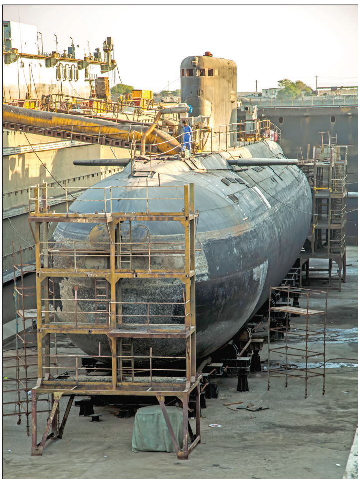
تعمیرات اساسی زیر دریایی کیلو کلاس طارق در کارخانجات بندرعباس
