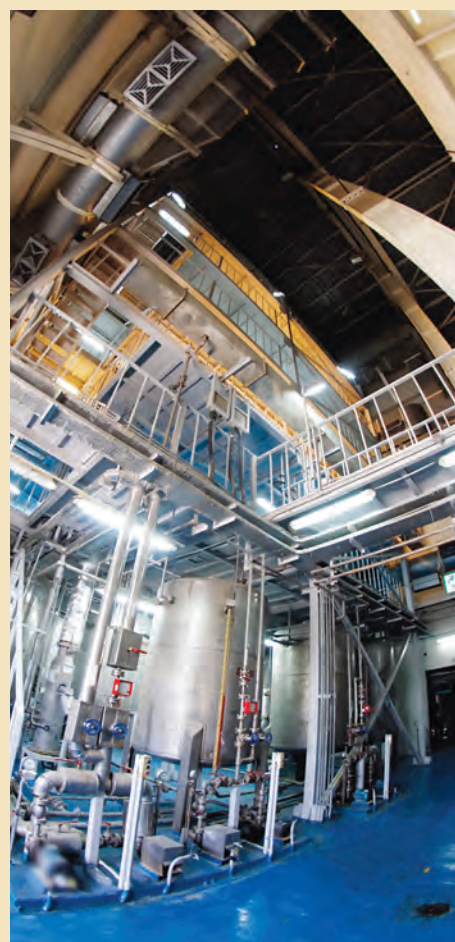
بخشی از خط تولید U_3O_8 بیست درصد غنی شده برای سوخت راکتور تهران
