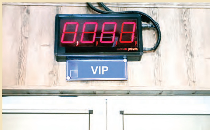
دستگاه نشان دهنده میزان تشعشعات در واحد تولید دی اکسید اورانیوم اصفهان
