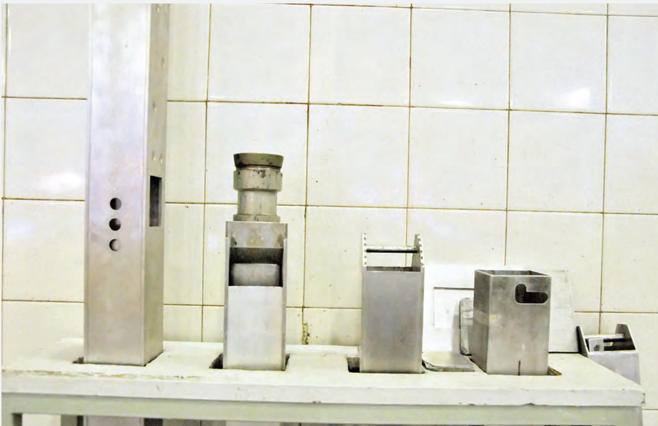
نمونه سوخت خارجی و محفظه‌های درون قلب راکتور
