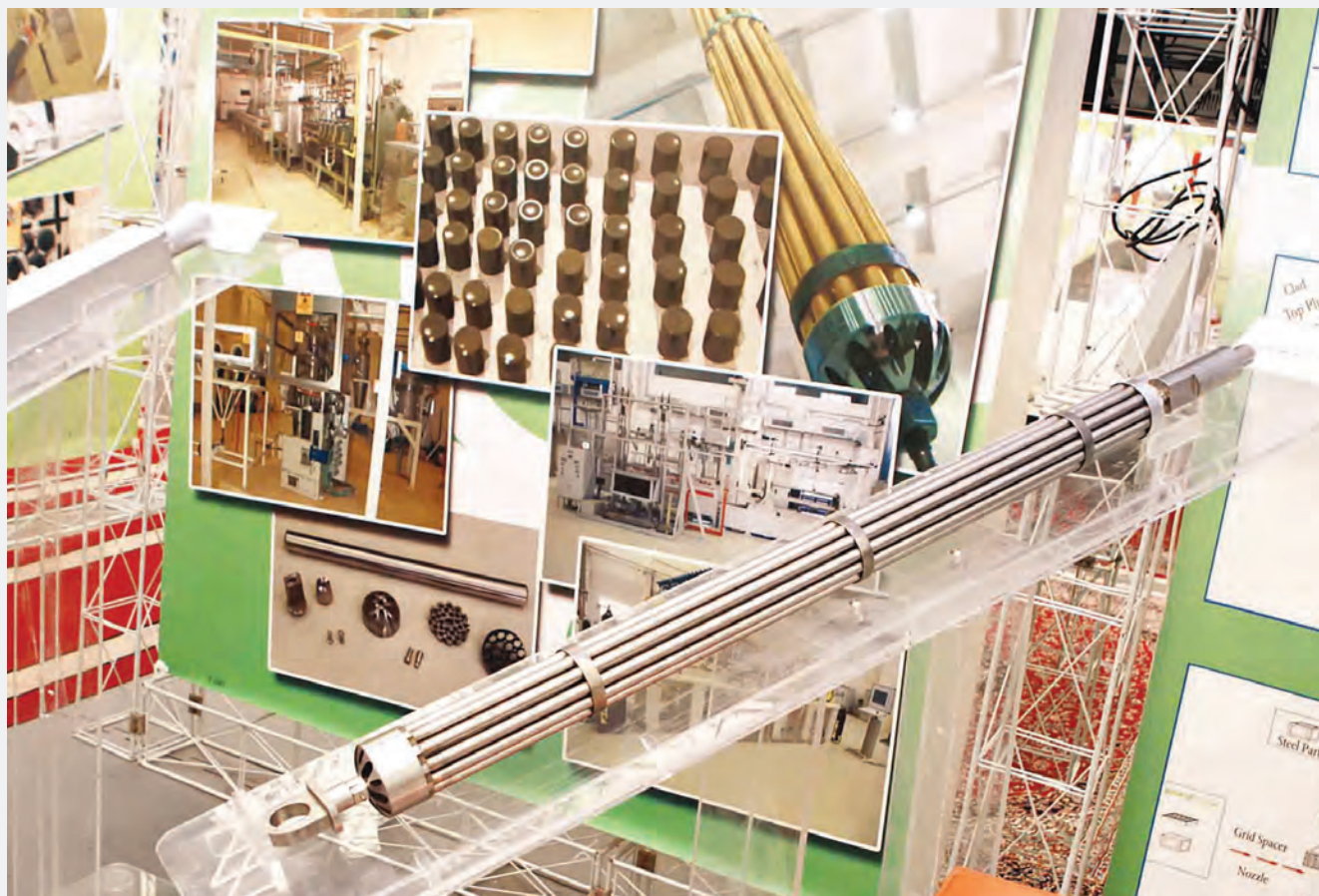
مجتمع سوخت راکتور صفر قدرت اصفهان (ZPR) ساخته شده در کارخانه FMP
