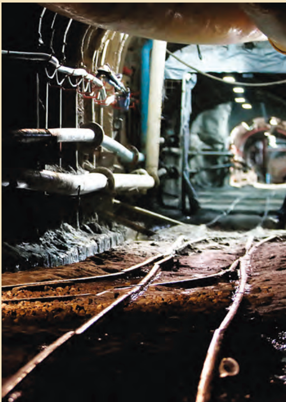
تونل معدن زیرزمینی اورانیوم ساغند و تجهیزات انتقال آب و برق
