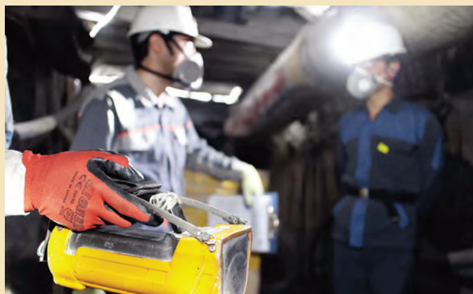
دستگاه اکسیژن و متر برای تعیین عیار اورانیوم موجود در سنگ معدنی و پیدا کردن گه‌های اورانیوم
