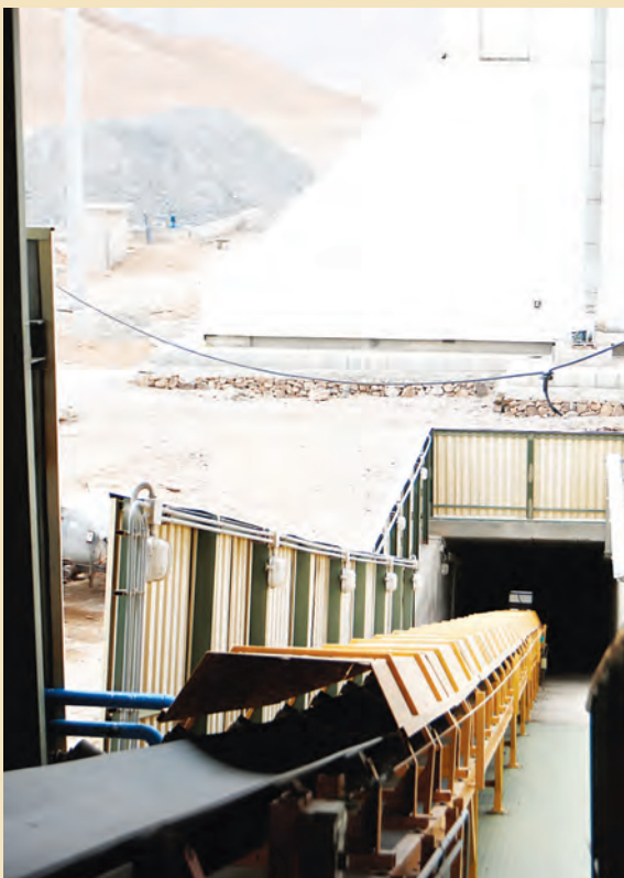
ورودی سنگ معدن اورانیوم به خردکن ثانویه و ابتدای خط تولید کیک زرد
