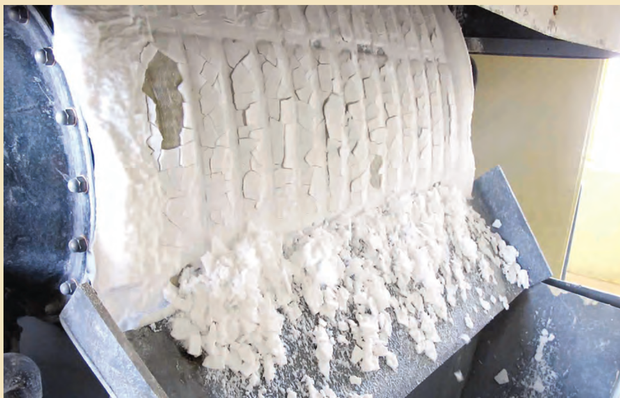
فیلتر جذب رطوبت از دی اکسید زیر کونیوم با گرید هسته‌ای بعد از جداسازی هافنیوم
