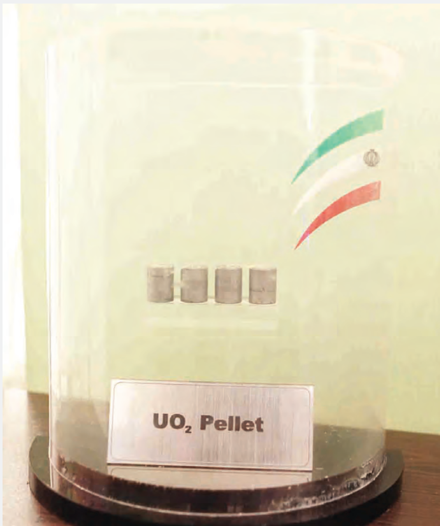
▲ نمونه قرص سوخت راکتور آب سنگین اراک
