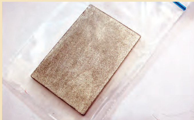
U3O8 ۲۰ در صد غنی شده (میت) که در ساخت صفحه سوخت راکتور تهران به کار می‌رود
