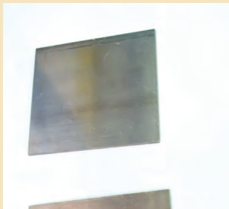
پوشش آلومینیومی دوطرف میت قبل از نور دو تبدیل به صفحه سوخت
