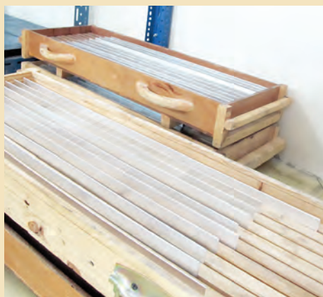
صندوق صفحات سوخت قبل از قرار گرفتن در مجتمع سوخت
