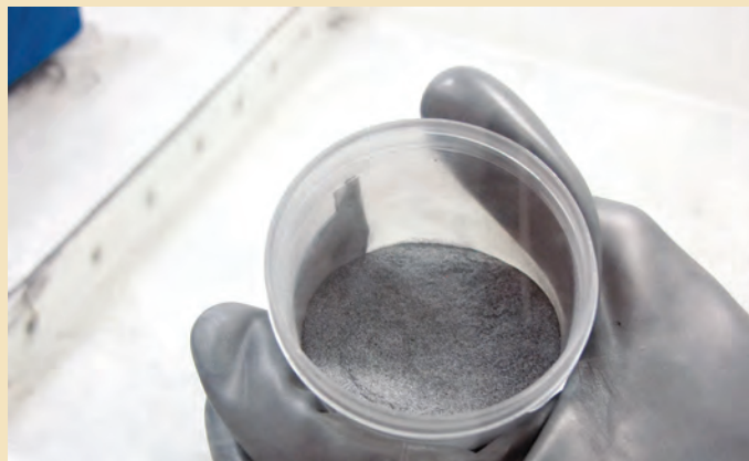
مخلوطی از U3O8 بیست در صد غنی شده با آلومینیوم
