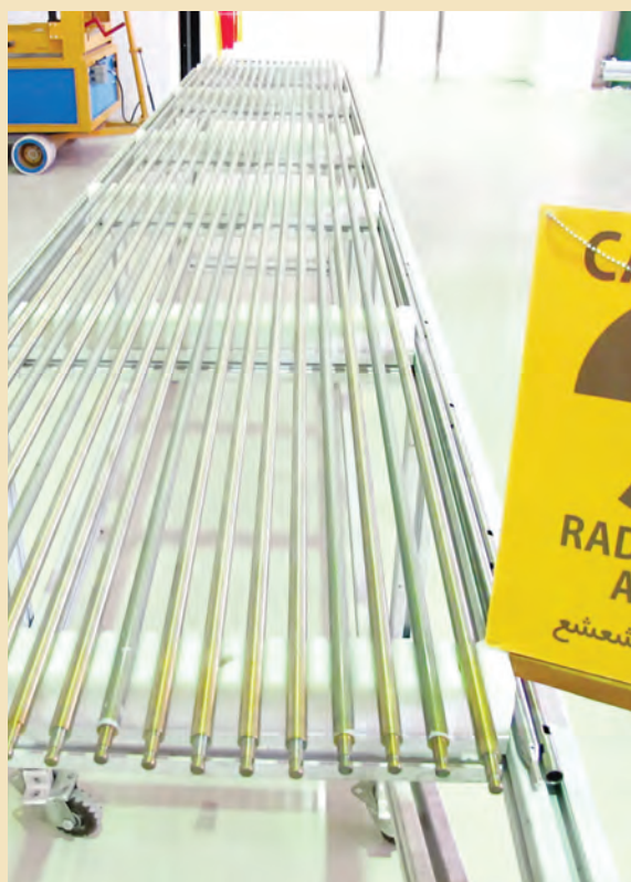
میله‌های سوخت مجمع سوخت اراک حاوی دی اکسید اورانیوم طبیعی
