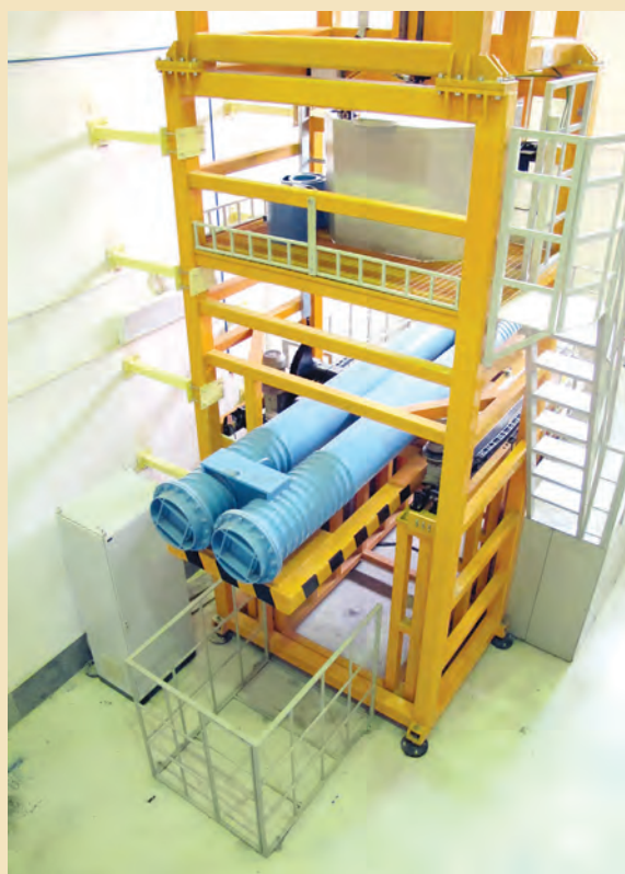
محفظه های حمل و نقل مجمع سوخت راکتور بوشهر ساخته شده در مجمع FMP
