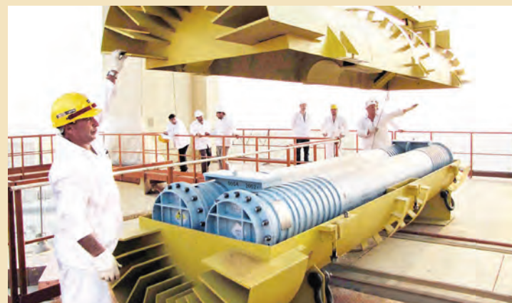
مجموعه های سوخت روسی راکتور هزار مگاواتی نیروگاه اتمی بوشهر داخل کسک های حمل سوخت
