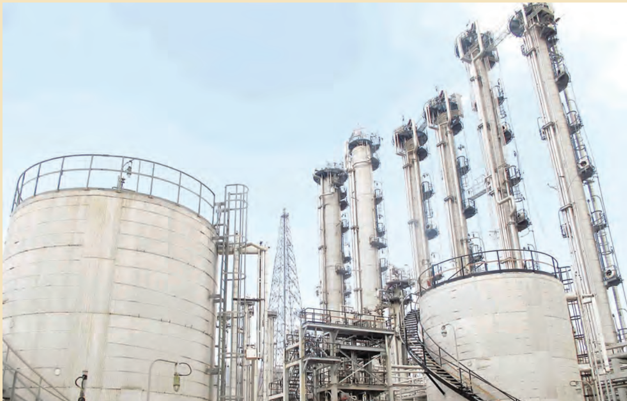
واحد تبادل دو دمایی برای تولید آب سنگین با غنای ۱۵ درصد
