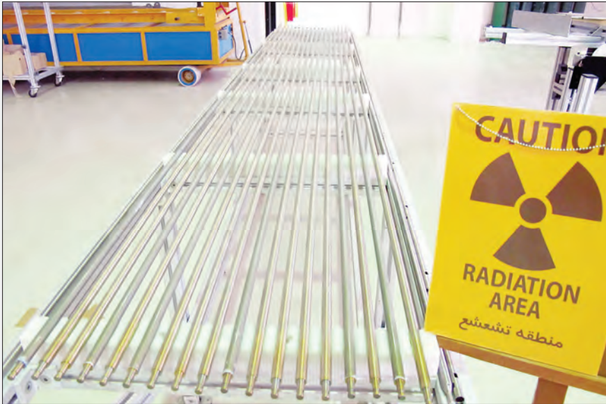
میله‌های سوخت مجتمع سوخت اراک حاوی دی‌اکسید اورانیوم طبیعی
