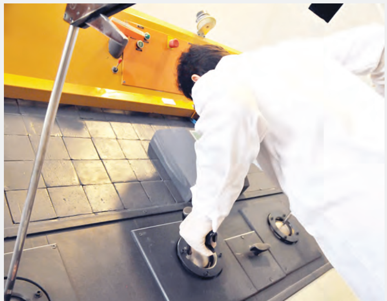
▶ اپراتور هات سل در حال استفاده از اهرم‌ها برای تولید رادیو دارو از عناصر رادیو ایزوتوپ
